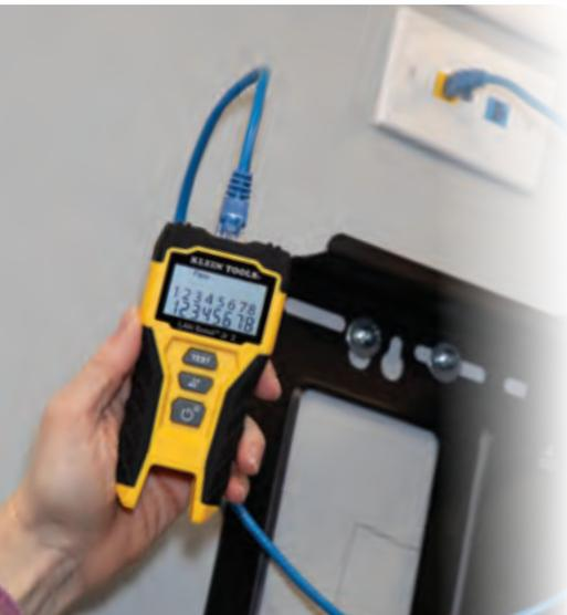
Rápidas respuestas LCD que indican el estado del cable
