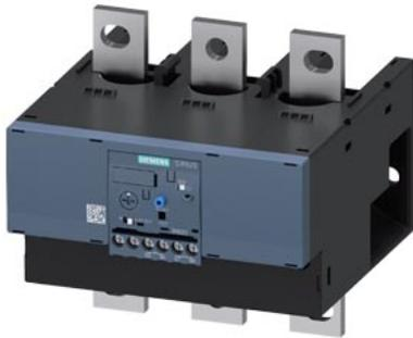
Relé de sobrecarga 55...250 A para protección de motores Tamaño S10/S12, CLASE 10E Montaje en contactor/independiente Circuito principal: conexión para barra circuito auxiliar: bornes de tornillo REARME manual/automático
